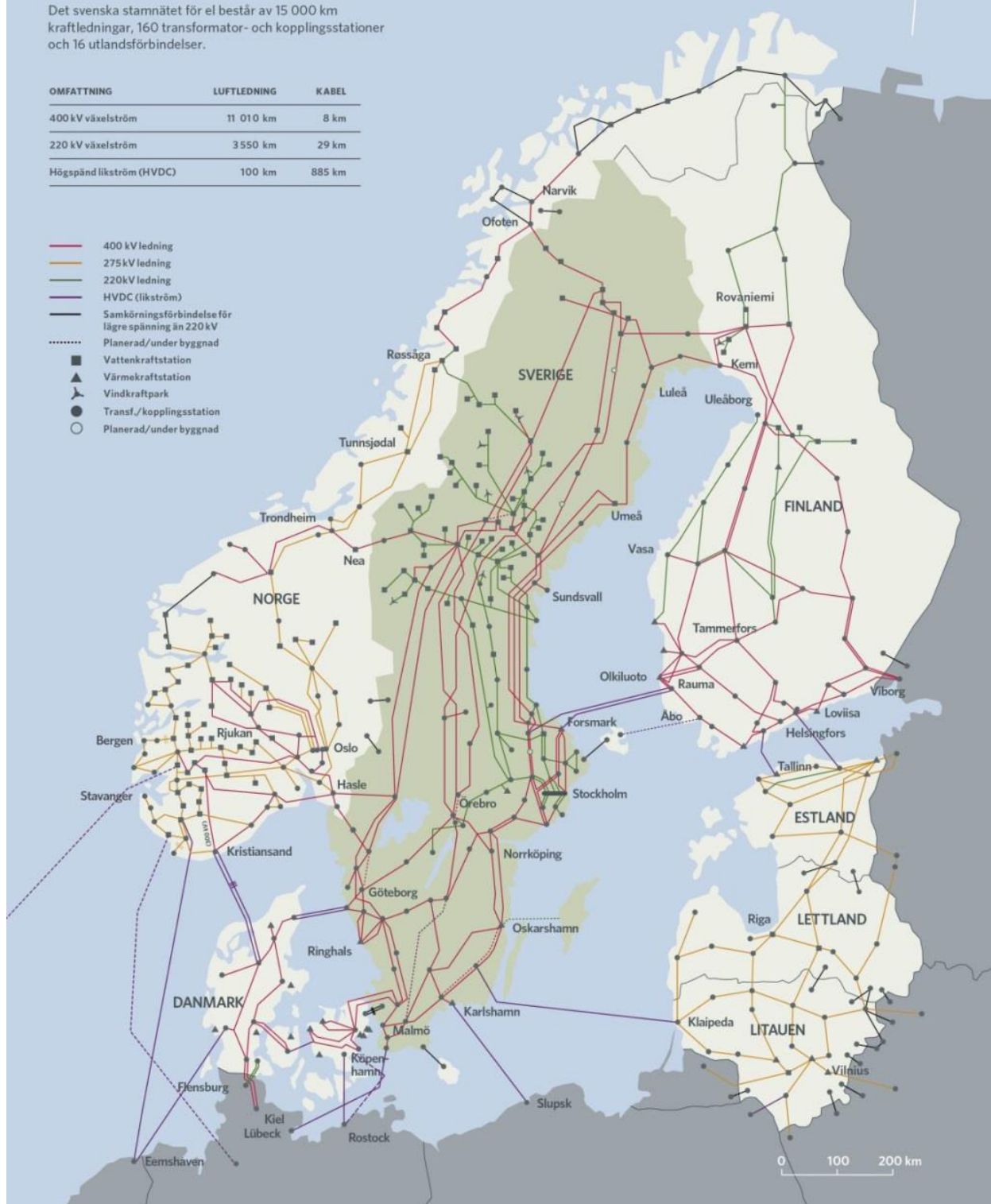
Figur 2: Bild av det Svenska stamnätet och dess förbindelser till utlandet. De röda linjerna är 400 kV AC-ledning, de gröna linjerna är 220 kV AC-ledning, de gula linjerna är 275 kV AC-ledningar och de lila linjerna är DC-linor på varierande spänningar (Svenska Kraftnät, 2016-09-12b.)
