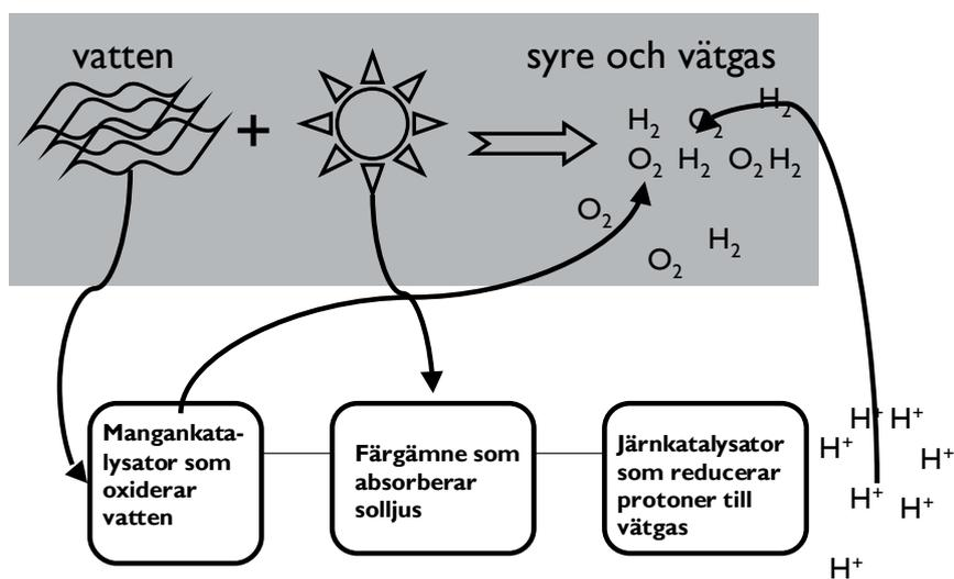
Figur 30. Schematisk bild av ett artificiellt fotosyntessystem.
