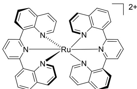
Figur 31. Ruteniumkomplexet som har ett exciterat tillstånd som lever i tre mikrosekunder.
