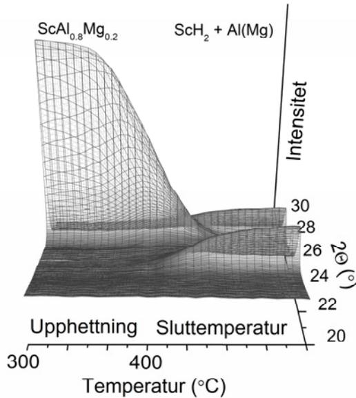
Figur 1. Studie av reaktionen då  $\text{ScAl}_{0.8}\text{Mg}_{0.2}$  absorberar väte och sönderfaller till  $\text{ScH}_2$  och  $\text{Al(Mg)}$ .
