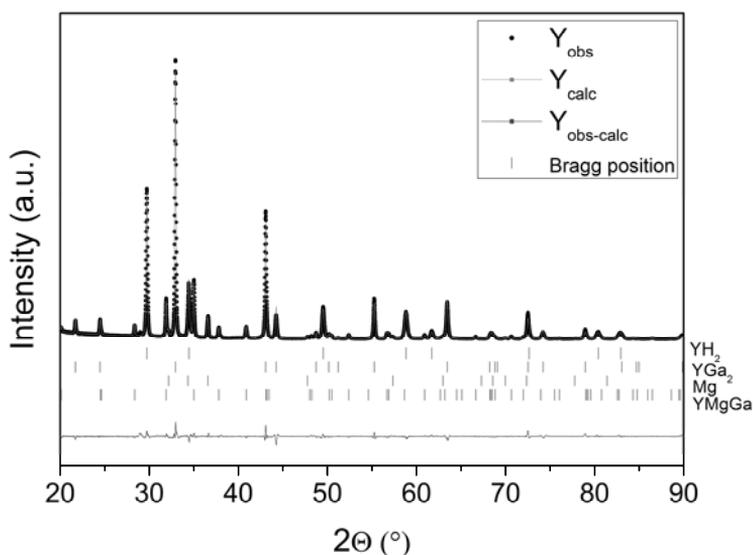
Figure 5.8. XRD pattern of desorbed  $\text{YMgGa}$ .
