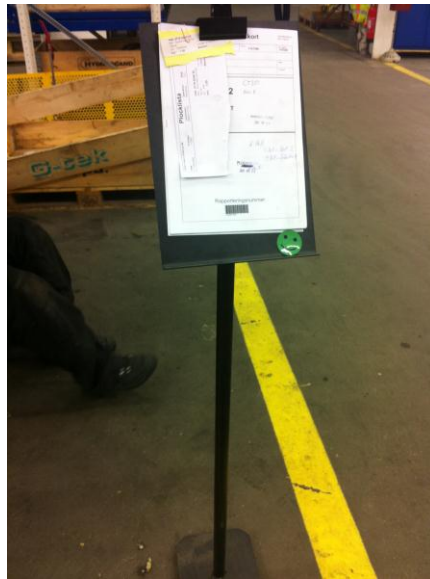
Figur 1.2 Ställ för arbetskort för en monteringsstation. Det aktuella arbetskortet är rättidigt.
