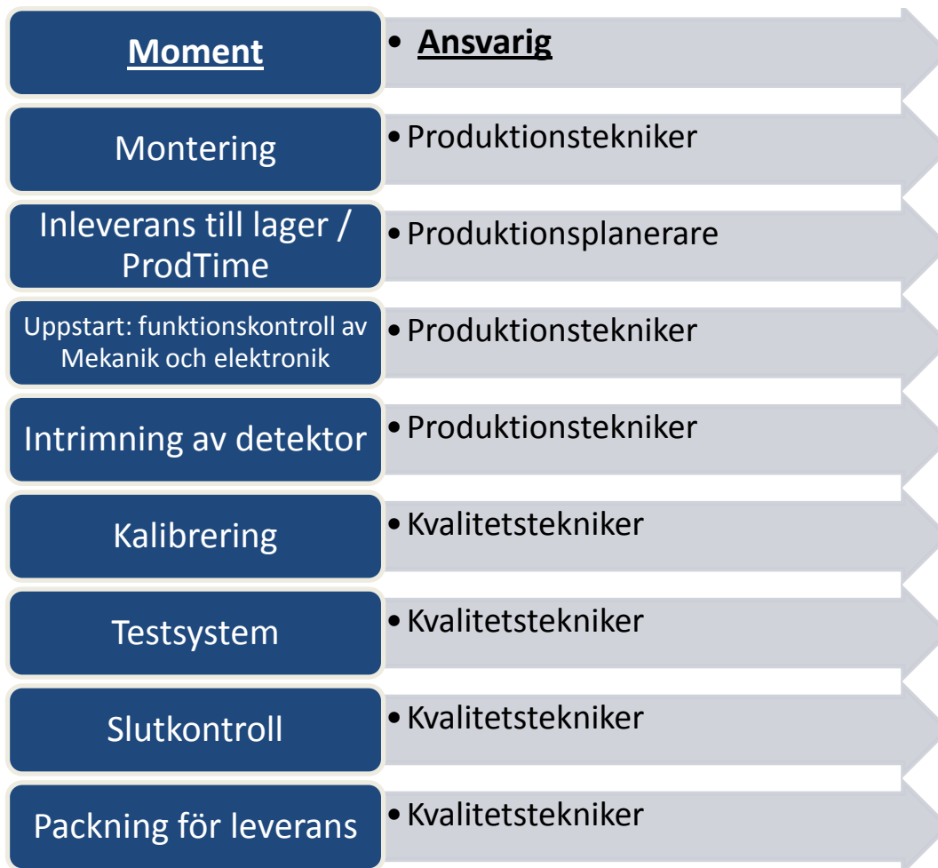
Figur 1 – Flöde tillverkning och kvalitetsmoment
