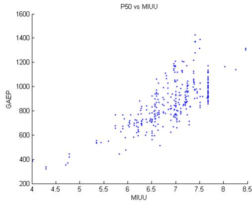
Figure 21: GAEP ( $\text{kWh}/\text{m}^2$ ) vs MIUU ( $\text{m}/\text{s}$ )
