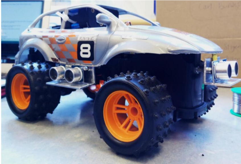
Figur 9: Andra monteringen av sensorerna.
