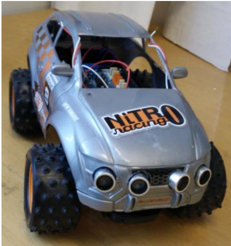
Figur 7: Första monteringen av sensorer, sett från utsidan
