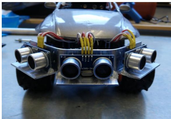
Figur 11: Slutgiltig montering av sensorerna
