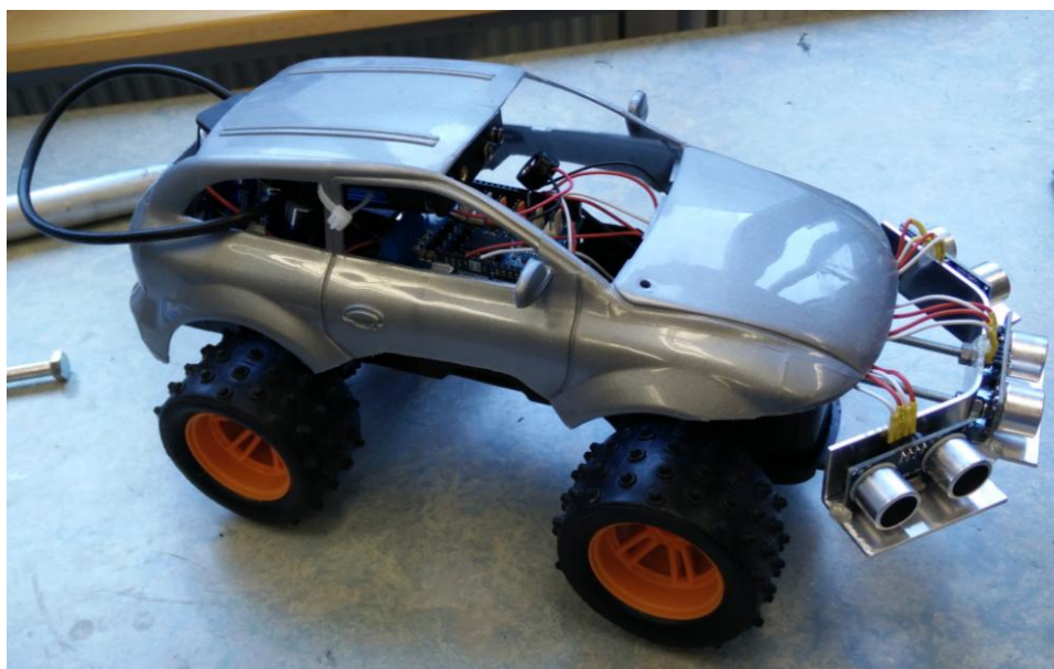
Figur 13: Den färdiga bilen sedd snett uppifrån, man kan ana den ena batterihållare uppe i taket och Arduinokorten under denna.
