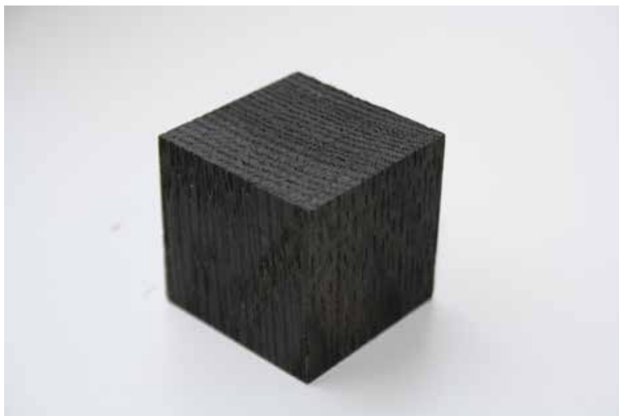
Kub av ekrä som används vid hållfasthetstester. Foto: Alexey Vorobyev, UU.
