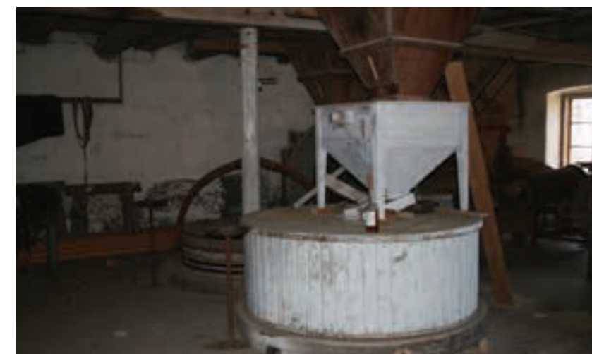
Interiör från kvarnen i Alsta visar det träfodral där kvarnstenarna var inneslutna och den tratt genom vilken spannmålen hällades ned.
