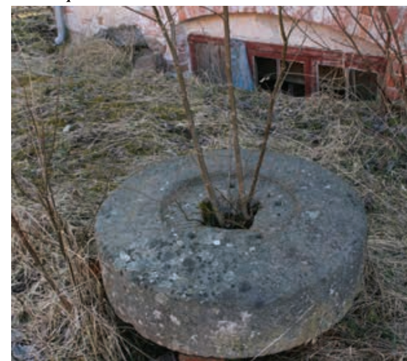
Utanför kvarnen i Alsta ligger i dag flera förbrukade kvarnstenar. Ända fram till 1900-talets början gjordes stenarna av granit eller annan hård stenart. Redan under medeltiden fanns en export av kvarnstenar i porfy från Dalarna. Stenarna vara tvungna att renoveras regelbundet. De lyftes då upp ur sitt träfodral med en speciell lyftanordning och mjölnaren fick sedan hugga nya spår med mejsel och hammare.
