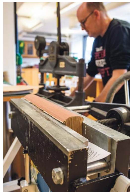
Längst fram en falsslagningspress som används för att "forma" ryggen på boken. I bakgrunden sätter Roger Johansson in en bok för en snabb inpressning i en knäledspress.
