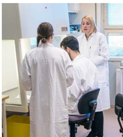
Laminärflödesbänken har en fläkt som suger ut luften. Det innebär att eventuella luftburna partiklar hamnar i filtret.
